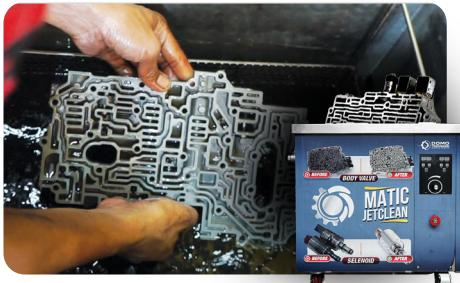
Proses membersihkan body valve dan solenoid dari butiran kotoran penyebab jedug, slip, delay, dst. Menggunakan mesin khusus dengan teknologi Jerman.
